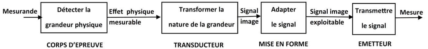
La fonction **détecter la grandeur physique** est assurée par le **corps d'épreuve**, l'organe qui reçoit directement l'action de la grandeur physique et produit un effet transformable en signal mécanique, électrique, pneumatique, etc.
