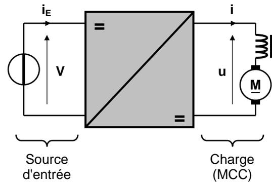
Lors des phases de mise en mouvement ou de maintien à vitesse constante, la source d'entrée fournit de la puissance électrique à la MCC qui la convertit à son tour en puissance mécanique (fonctionnement moteur). Lors des phases de freinage, on peut récupérer une partie de l'énergie cinétique en faisant transiter la puissance de la MCC vers la source (fonctionnement génératrice).
