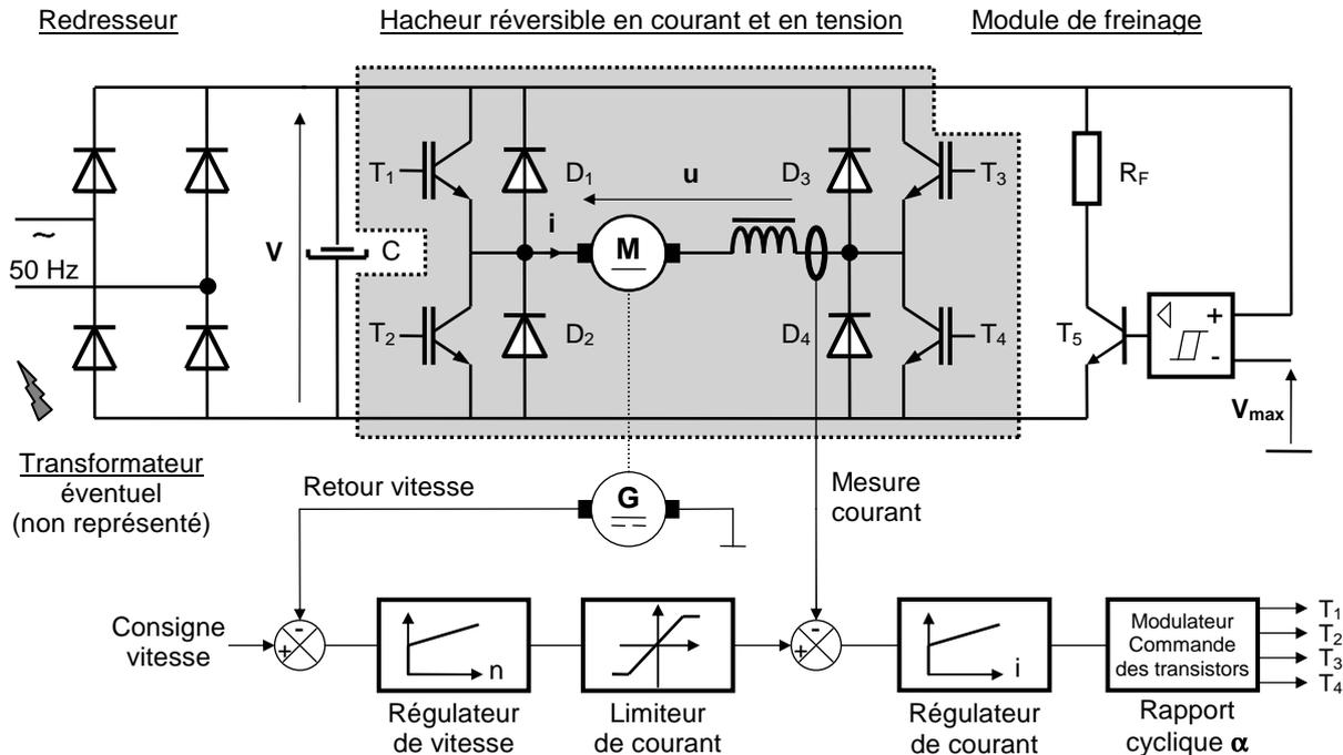
a) Dans toutes les structures proposées, les transistors **IGBT** peuvent être remplacés par des **transistors MOS de puissance**.
