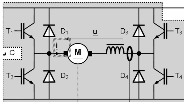
On rappelle qu'un transistor commandé à l'amorçage (IGBT, MOS) ne devient **passant** que si le courant d'induit  $i_c$  prend la polarité correcte.
