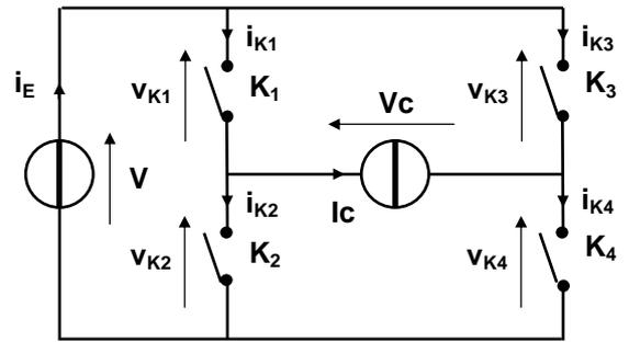
On se limite ici à ce cas. La commande des interrupteurs  $K_1$  et  $K_2$  d'une part,  $K_3$  et  $K_4$  d'autre part, est toujours **complémentaire** :
