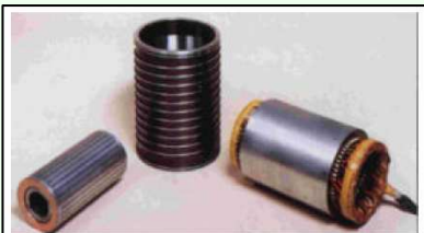
moteur asynchrone (broche UGV) très grande vitesse 200 kW – 100 000 tr/mn (20 N.m)
