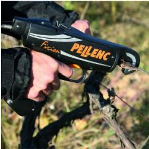
L'attacheur de lien est utilisé dans les vignes pour attacher les sarments sur les fils métalliques. Ce système est autonome énergétiquement. Il est équipé d'une batterie de 6000mAh.
