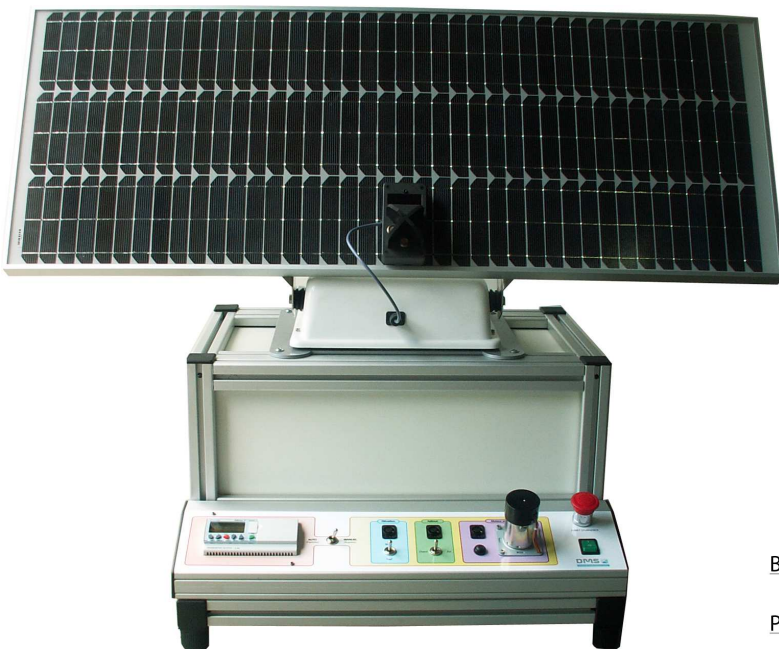
Fig 1 : Vue d'ensemble du panneau solaire asservi
