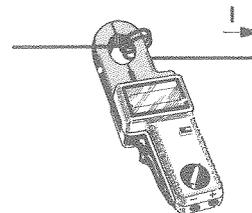
Une meilleure précision peut être obtenue en enroulant plusieurs fois autour de l'un des bras de la pince le conducteur où circule le faible courant à mesurer.
