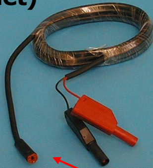
Terminaison de 120 ohms installé d'origine dans le connecteur
