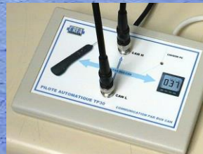
Boîtier Bus CAN connecté au pilote
