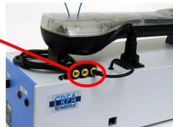
Le réseau doit ensuite être alimenté sous 12V continu. Pour cela utiliser le câble d'alimentation pourvu d'une prise réseau rouge et de deux fiches mâles rouge et noire.
