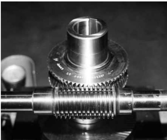
Lorsque le débattement angulaire de la chaîne cinématique est imposé et éventuellement ajusté au cours de la durée d'utilisation, l'engrenage **CMD** de type **Y** à jeu de denture réglable répond parfaitement, car il permet par construction, de régler le jeu de denture et assurer une grande régularité cinématique par la précision des dentures obtenue.
