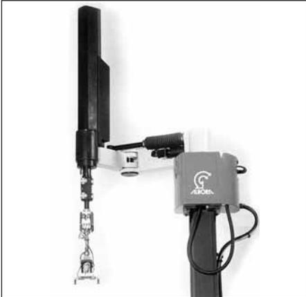
La société Allibert équipe ses presses de robots manipulateurs chargés d'extraire de la matrice une pièce "plastique" (fauteuil), la positionner pour contrôle et découpe du cordon d'alimentation puis la stocker sur une aire appropriée en vue de son conditionnement.
