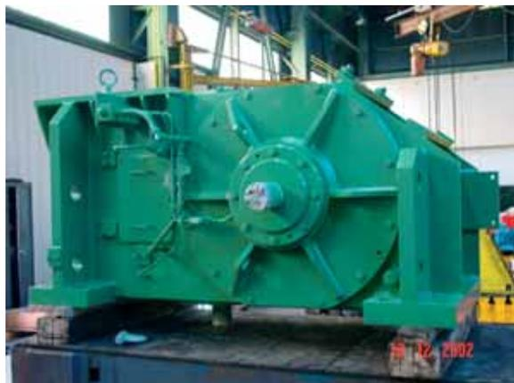
Gamme d'engrenages à vis JUMBOFLEX d'entraxe 610, 630 et 800 mm, rapport 9 à 17, moteur à courant continu, vitesse variable à couple constant de 0 à 525 tr/min, fonctionnement 24 heures par jour, le couple de sortie maxi est 129200 Nm à 29.3 tr/min (étirage de tubes acier).
