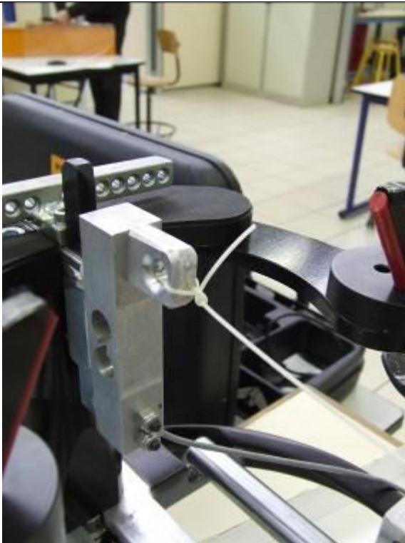
Cellule de force (mesure réelle de la tension du cordage)
