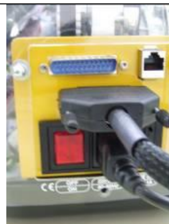
Liaisons extérieures de la cordeuse vers l'acquisition et le contrôle par carte externe
