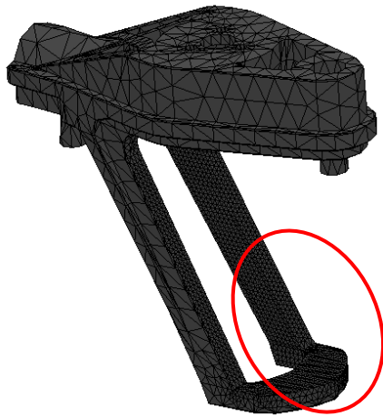
Maillage localement plus précis : permet d'exprimer au mieux la contrainte maximale sans trop influencer le temps de calcul
