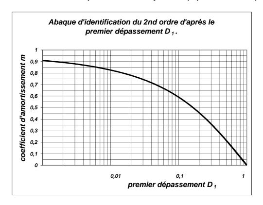
$\triangleright$  Détermination de la pulsation propre  $\omega_0$  à partir de la valeur de la demi pseudo période  $\Delta$  d'oscillation en utilisant l'abaque ci-dessous :
