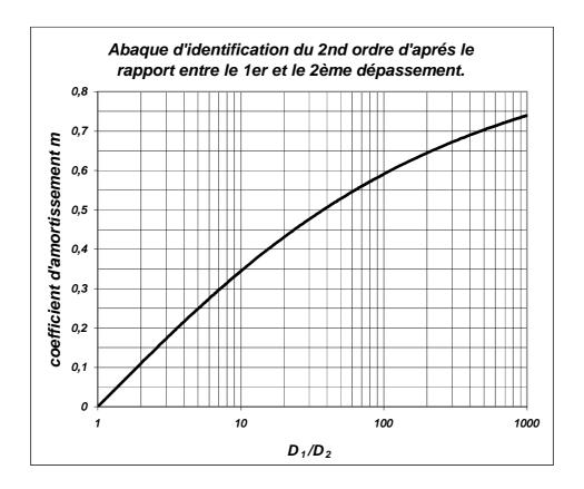
$\triangleright$  Détermination de la pulsation propre  $\omega_0$  à partir de la valeur de la pseudo période  $T_A$  d'oscillation et en utilisant l'abaque ci-dessous :
