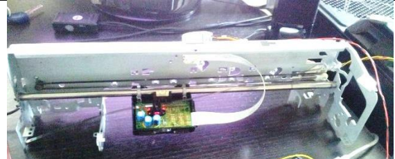
Fig.3 : exemple 3, imprimante / scanner, mise en position de la tête d'impression ou de lecture avance du papier
