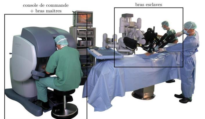
Figure 1 Robot Da Vinci lors de la phase de vie « en opération »
