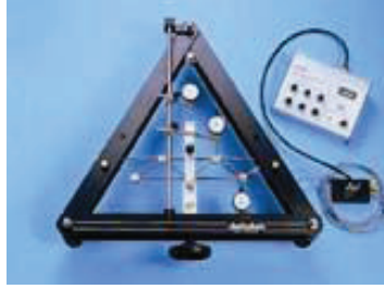
EX150C6 APPAREIL D'ETUDE D'UNE STRUCTURE A BARRES Comprend : Système triangulé de type fermette équipé de jauges (nécessite pont d'extensométrie EI616)
