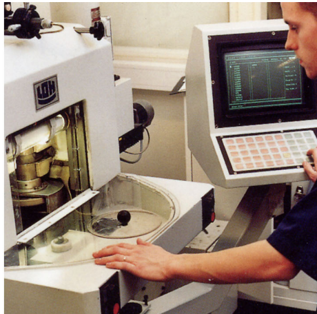
Figure 27.4 GAUCHE : Machine avec outil diamanté ; DROITE : Polissage de lentilles
