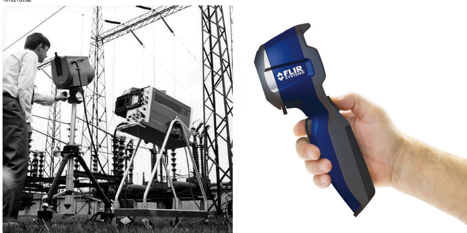
Figure 27.2 A GAUCHE : Thermovision® modèle 661 de 1969. La caméra pesait environ 25 kg, l'oscilloscope 20 kg et le trépied 15 kg. L'opérateur a également utilisé un groupe électrogène de 220 V CA et un récipient de 10 l d'azote liquide. A gauche de l'oscilloscope, on distingue le Polaroid (6 kg). A DROITE : FLIR i7 de 2009. Poids : 0,34 kg, batterie comprise.
