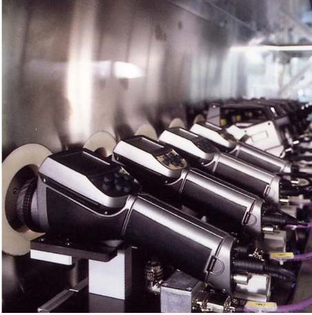
Figure 27.5 GAUCHE : Test de caméras infrarouge en chambre climatique ; DROITE : Robot utilisé pour le test et l'étalonnage des caméras
