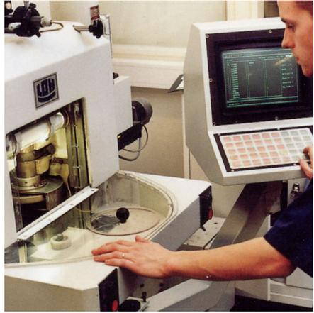
**Figure 2.4 GAUCHE :** Machine avec outil diamanté ; **DROITE :** Polissage de lentilles
