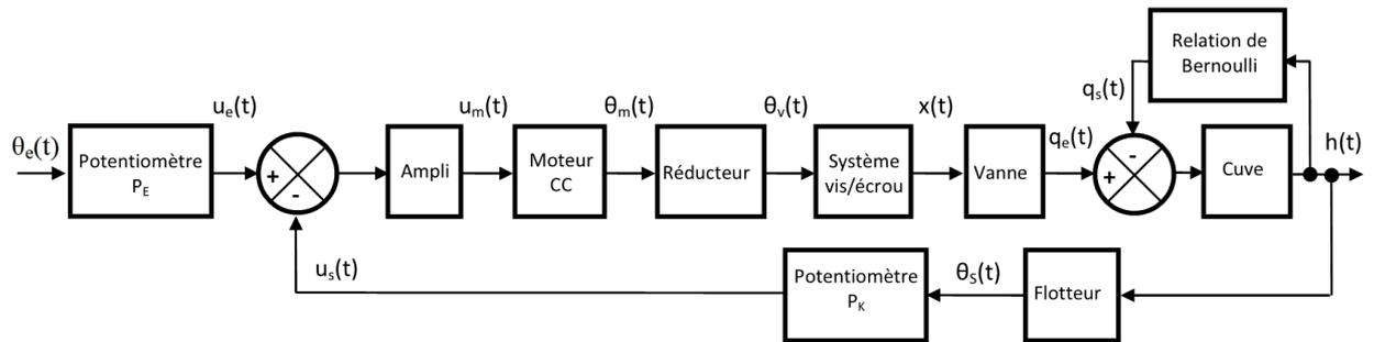
Remarque : la boucle qui comprend le bloc relation de Bernoulli n'est pas une boucle d'asservissement, elle représente la modélisation retenue comme modèle de connaissance de la cuve à fuite. La seconde boucle est par contre une boucle d'asservissement.
