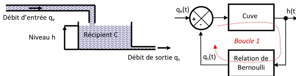
Remarque : la boucle 1 n'est pas une boucle d'asservissement, elle représente la modélisation retenue comme modèle de connaissance de la cuve à fuite. La boucle 2 est par contre une boucle d'asservissement.
