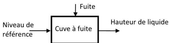
Volume d'eau dans la cuve :  $v(t) = \text{Surface} \cdot h(t)$
