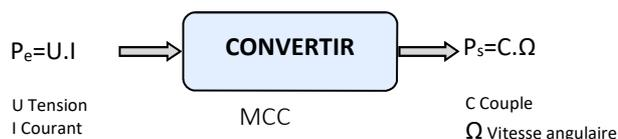
La machine à courant continu est un actionneur très utilisé en petites puissances (on peut en trouver une centaine dans une automobile). Elle est le plus souvent à aimants permanents, qui fournissent le champ magnétique inducteur. En propulsion, elle tend à être remplacée par des machines alternatives de type synchrone, même si les sources d'alimentation restent des batteries).
