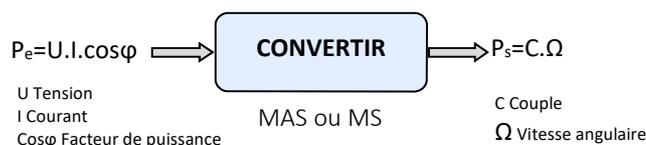
La machine asynchrone est très répandue dans l'industrie. Elle est triphasée et caractérisée par deux niveaux de tension d'alimentation, sa vitesse de rotation et sa puissance de sortie (mécanique) en Watts.
