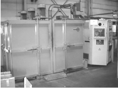
Une entreprise est équipée de fours horizontaux de marque « Thermidor », utilisé pour le traitement de stabilisation de pièces nécessaire à l'industrie automobile.
