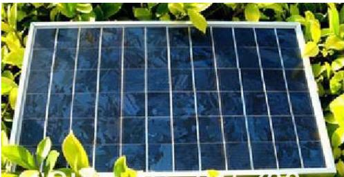
En fonctionnement on mesure une tension de 12V et un courant de 2A. Sans raccorder la pompe de la fontaine, on mesure aux bornes du panneau solaire une tension de 13V.
