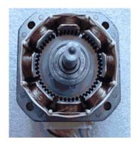
Le moteur pas à pas est un moteur qui tourne en fonction des impulsions électriques alimentant ses bobinages et font un pas par impulsion.
