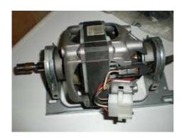
On observe dans ce type de moteur des étincelles au niveau du collecteur (perceuse, aspirateur, moteur d'essorage de machine à laver...)
