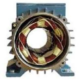
Les bobinages inducteurs alimentés en triphasé sont placés au stator et génèrent un champ magnétique tournant.
