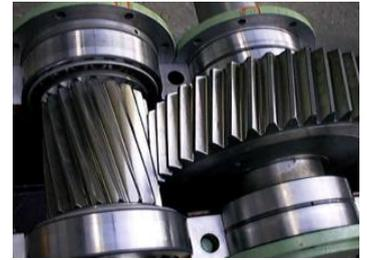
Engrenage à denture hélicoïdale
