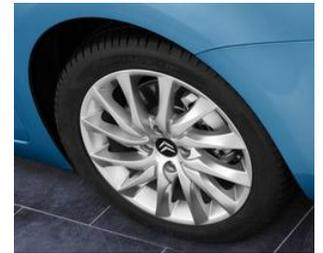
Diamètre pneu :  $D_{pneu} = 16 \times 25,4 + 2 \times 55\% \times 215 = 64,3 \text{ cm}$
