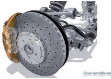
Systeme de freinage en céramique (Plus dur, accepte plus de chaleur)
