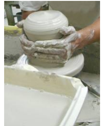
Façonnage d'une porcelaine (Photo Pillivuyt_Mehun sur Yèvre)
