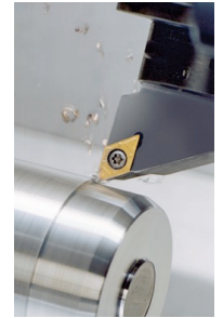
Cinématique du tournage : outil fixe et pièce tournante
