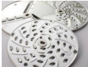
Emboutissage et découpage de lames de mixers
