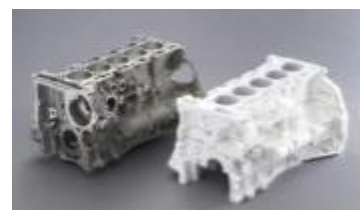
Bloc moteur GM Vortec (méthode « mousse perdue »)
