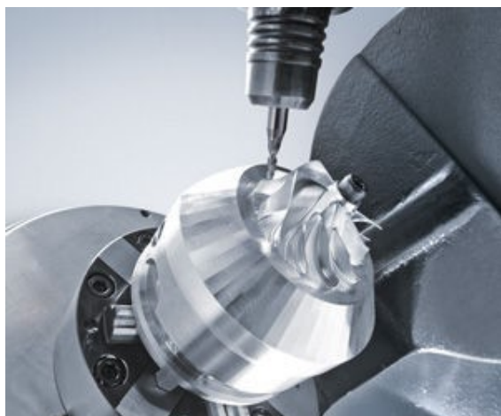
Pièce réalisée par UGV (usinage à grande vitesse)
