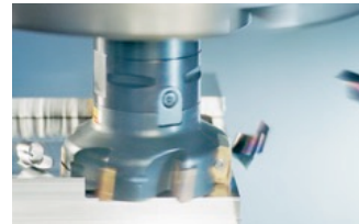
Cinématique du fraisage : outil tournant et pièce fixe
