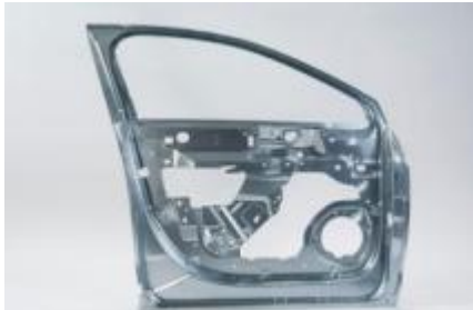
Emboutissage et découpage dans une portière de voiture
