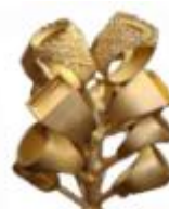
Bagues avant la phase de « dégrappage »
