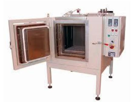
Une résistance électrique assure le chauffage à l'intérieur de l'étuve, un gradateur permettant de moduler la puissance dissipée par cette résistance. Un capteur de température, plus précisément une sonde au platine Pt100, mesure la température dans l'étuve. Un conditionneur assure la mise à niveau du signal de mesure pour être ensuite exploité par le régulateur (qui admet du 0-5V).
