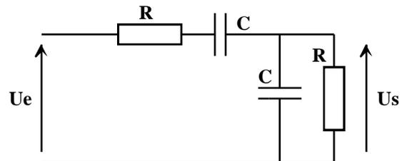
2) Pour rechercher la bande passante de ce montage, présenter sa fonction de transfert sous la forme
