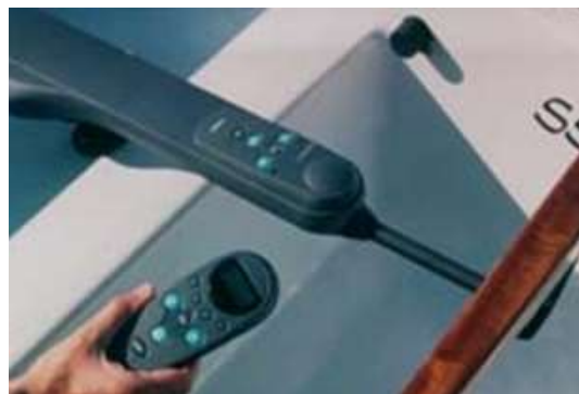
Pilote automatique de bateau : maintien de cap
