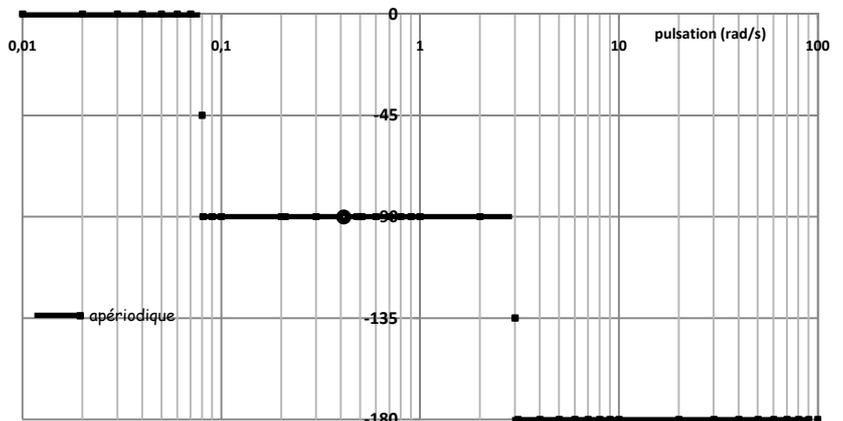
Diagramme de Bode réel de systèmes du deuxième ordre : tracés pour  $H(i\omega) = \frac{1}{1 + 0,2\xi i\omega + 0,01(i\omega)^2}$
