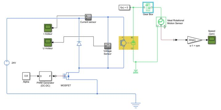
Attention à bien faire la différence entre les blocs Simulink (signaux) et les blocs Simscape (grandeurs physiques). La vitesse étant une variable de flux, comme la tension elle nécessite une référence.
