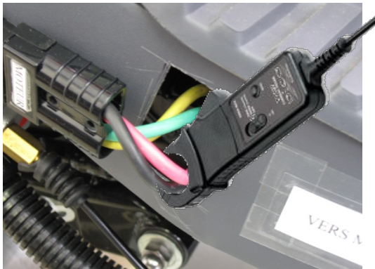
Points d'observation du courant moteur (fils par paire, passer ensemble ceux de couleurs rouge et noire dans la boucle de la sonde de courant).
