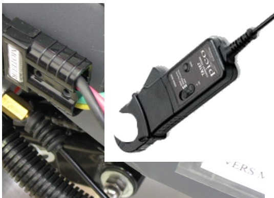
Points d'observation du courant moteur (fils par paire, passer ensemble ceux de couleurs rouge et noire dans la boucle de la sonde de courant).
