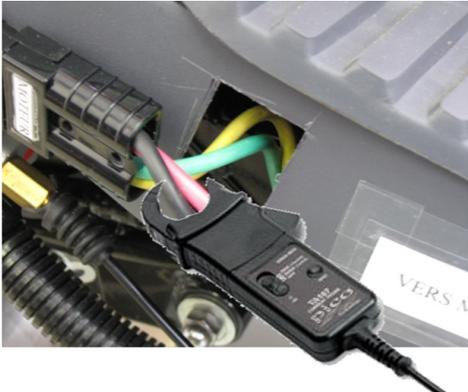
**Points de mesure sur le hacheur abaisseur**
