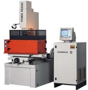
Des machines spécialisées dans le perçage rapide de matériaux durs utilisent le principe de l'électroérosion par enfonçage avec des électrodes tubulaires de faible diamètre et de grandes longueurs.
