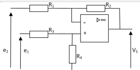
Si la relation  $S = f(e_1, e_2)$  répond bien au besoin d'amplification, les résistances d'entrée du montage ne sont pas nulles et le raccordement du montage amplificateur au pont de wheatstone va prélever de l'énergie sur le pont, dont modifier grandement la valeur de  $u_{AB} = (e_2 - e_1)$ .
