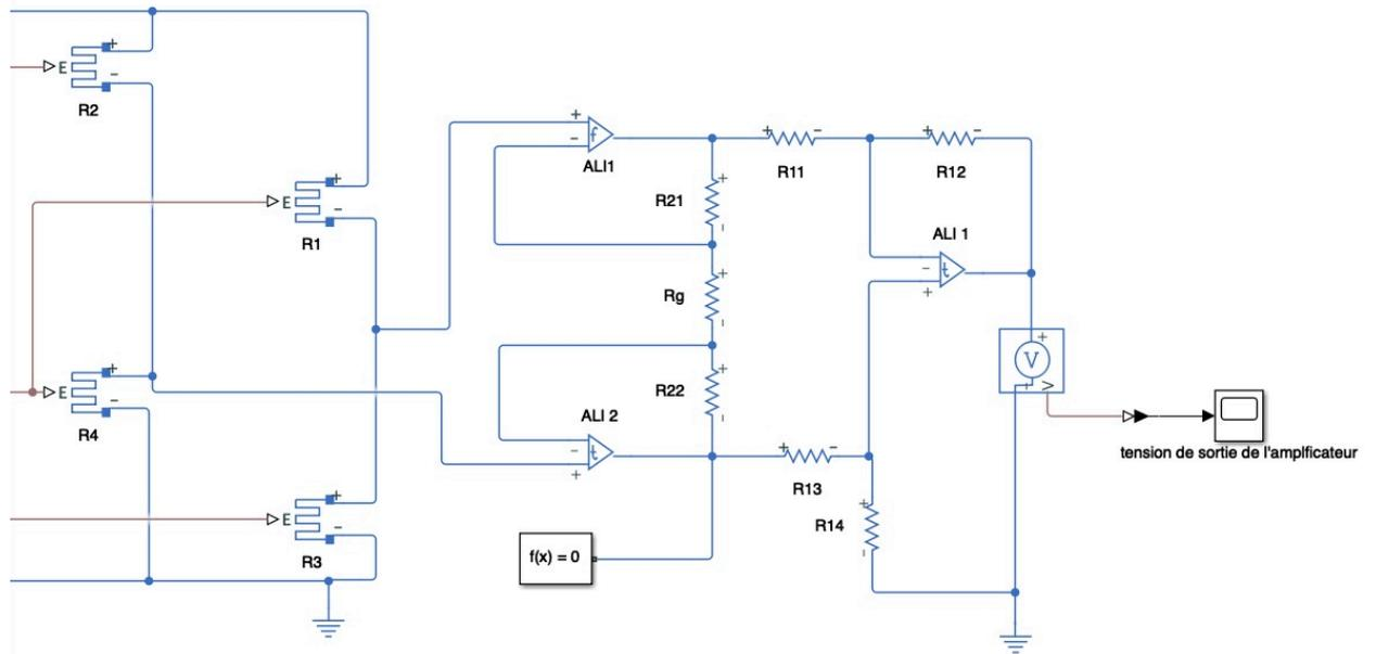
**Q8** Simuler le fonctionnement de l'amplificateur d'instrumentation (On donne  $R_{21} = R_{22} = 24,7 \text{ k}\Omega$ ,  $R_{11} = R_{12} = R_{13} = R_{14} = 10 \text{ k}\Omega$ , et  $R_g = 100 \Omega$ ).
