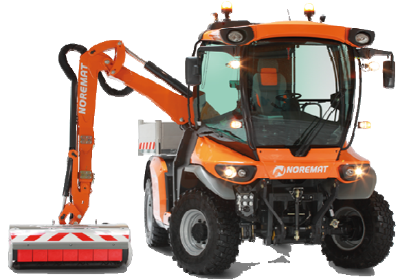
Figure 1 : véhicule VSV équipé d'un groupe de broyage
