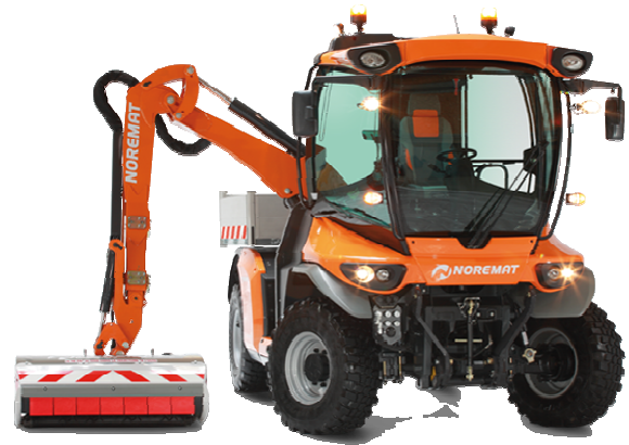
Figure 1 : véhicule VSV équipé d'un groupe de broyage
