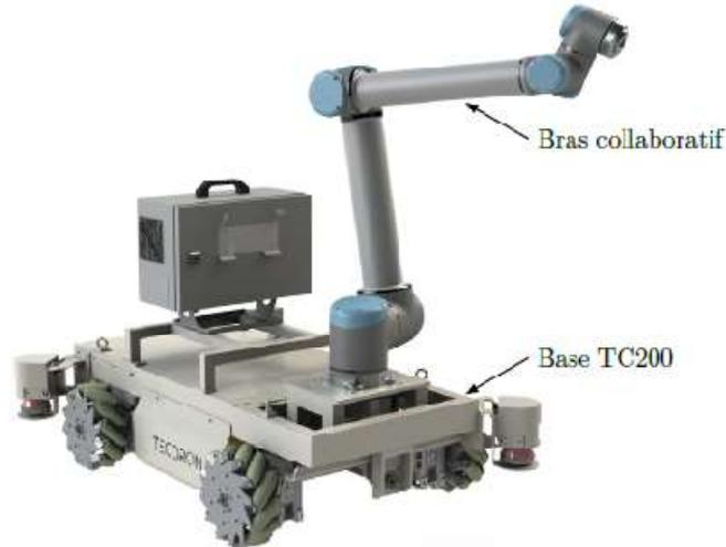
**Figure 1 :** robot collaboratif TC200 de Tecdron
