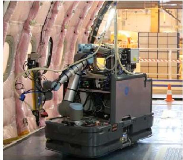
**Figure 2 :** robot collaboratif TC200 de Tecdron en milieu industriel
