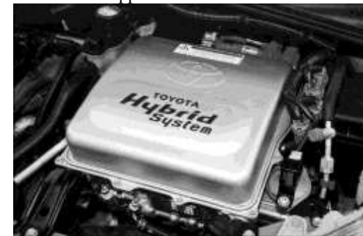
Figure 11: Convertisseur DC/DC + Onduleurs CV7 et CV9
