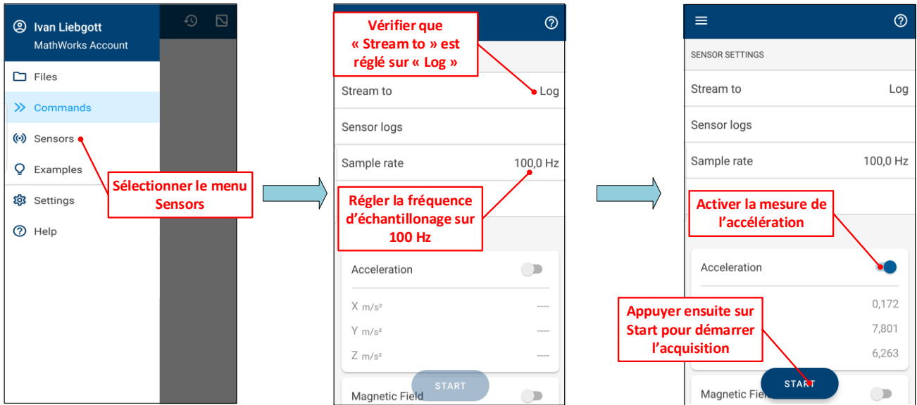
Figure 822 : configuration et démarrage d'une acquisition des mesures issues des capteurs du smartphone
