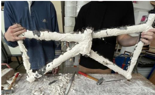
1) Fabrication du moule du cadre en plâtre
