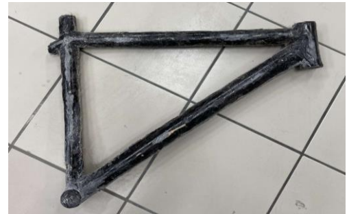
2) Confection du cadre à base d'un mélange de cheveux et de résine époxy
