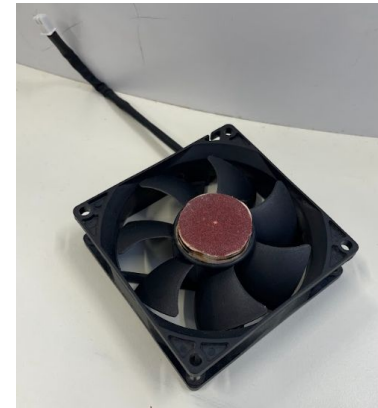
Ventilateur d'ordinateur, 2200 tr/min Papier de verre: P100
