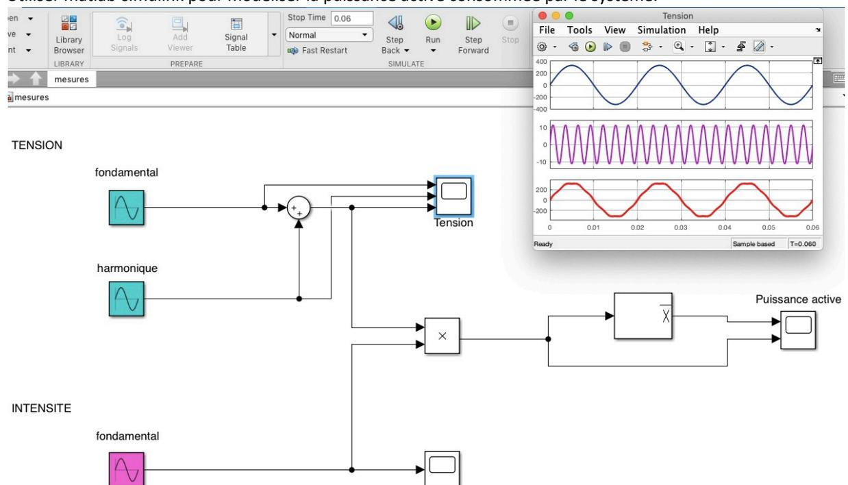
**Q9** Imprimer et commenter les allures de la tension réseau et de la puissance instantannée. Relever la valeur de la puissance active. Conclure sur la modélisation.
