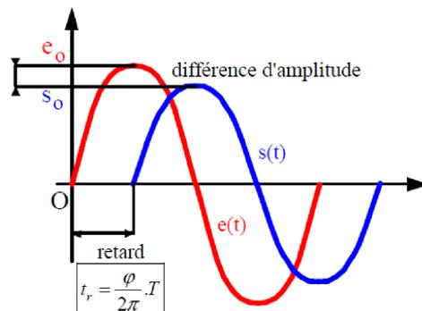
Q1. Réaliser plusieurs essais en sinusoïdal sur votre système avec une amplitude constante  $E_0 = 30 \text{ mm}$  et une fréquence variable. Vous relèverez pour chaque essai le déphasage entre l'entrée et la sortie ainsi que l'amplitude de la sortie : pour cela compléter le fichier excel fourni.
